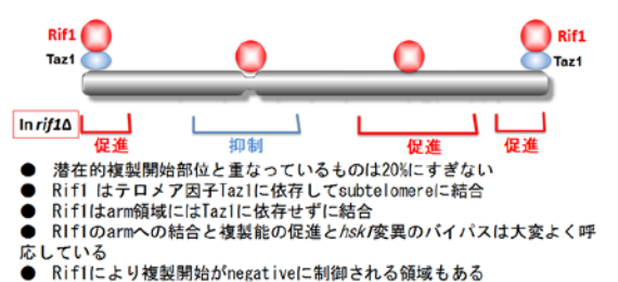
図6 Rif1の染色体結合のまとめ。Rif1は、染色体の特定の領域に結合する。テロメア側の領域はrif1欠損により複製開始が促進される起点が多く集まっており、セントロメア近傍は、rif1欠損により抑制される複製起点が存在する。
